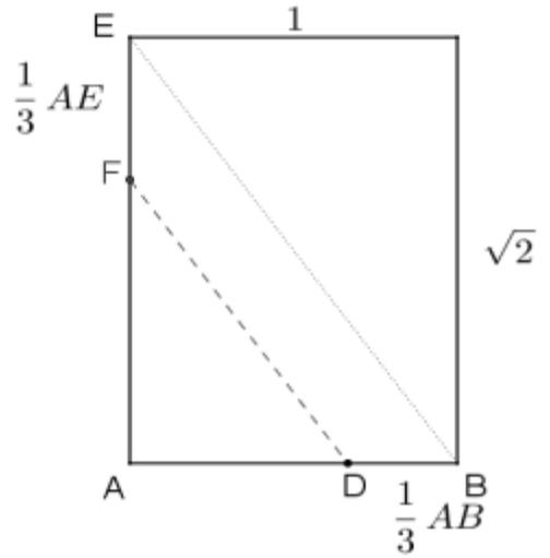
Si può utilizzare il teorema di Talete tracciando la parallela alla diagonale EB passante per D
